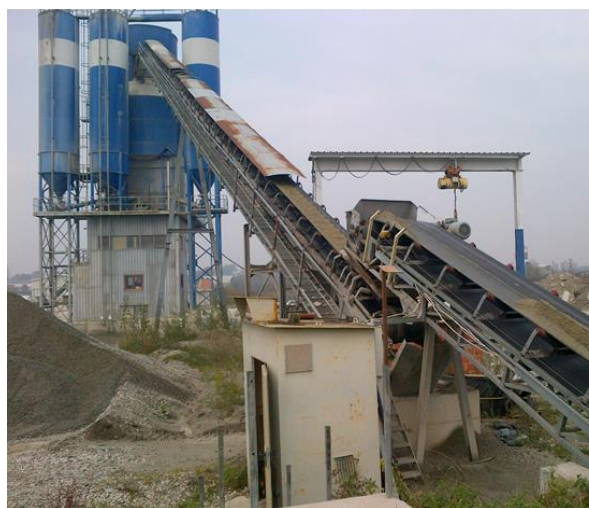
Slika 5. Transportni mehanizam za agregate
